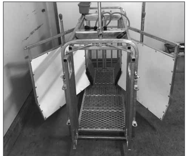
Le Draft Pro de Ritchie avec les trois portes de triages en position ouvertes
