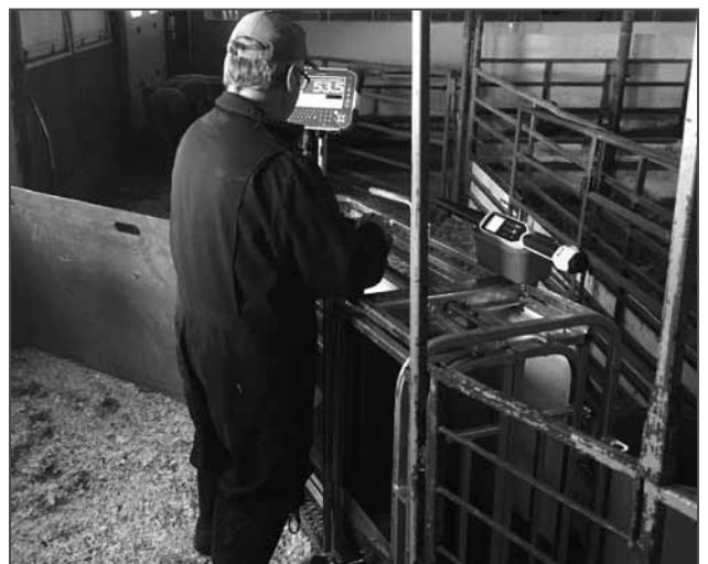
La position de l'opérateur sur le coté. Note : il n'est pas possible d'avoir accès aux commandes par l'arrière de la cage.
