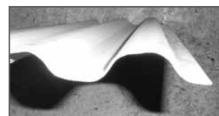
Photo 5. Panneau de PVC ondulé de la compagnie Agri-clé, la bordure est plus large et arrondie.
