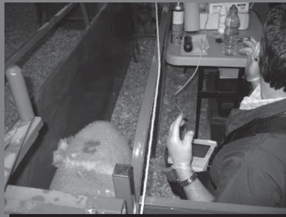
Mesures aux ultrasons réalisées par un spécialiste du Centre de développement du porc du Québec.
